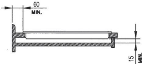
Die Wand oberhalb der Wandabschlussleiste im Bereich des Gerätes darf nicht aus einem brennbarem Material bestehen. Holz, Kunststoff, PVC-Folien usw. entsprechen nicht dieser Anforderung!
